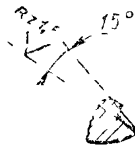
Форма заточки торцевых зубьев
